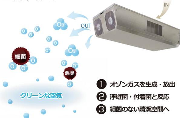
オゾンガスを生成させ室内に放出し浮遊菌・付着菌を殺菌します。オゾンが分解するときに発生する酸素原子が細菌の細胞膜に作用し死滅させます。
